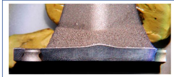
Querschliff Schweißnaht
