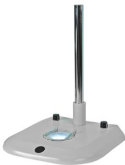
Bild 22: Großes Stativ mit Säule 367 mm, LED Durchlicht und eingebauter Stromversorgung
