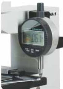
Bild 23: Messuhr für Tiefenmessung
