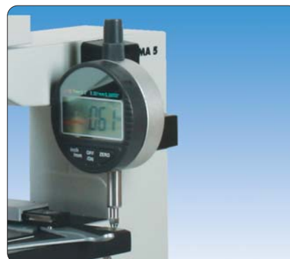
Tiefenmessung mit digitaler Messuhr depth measurement with digital meter
