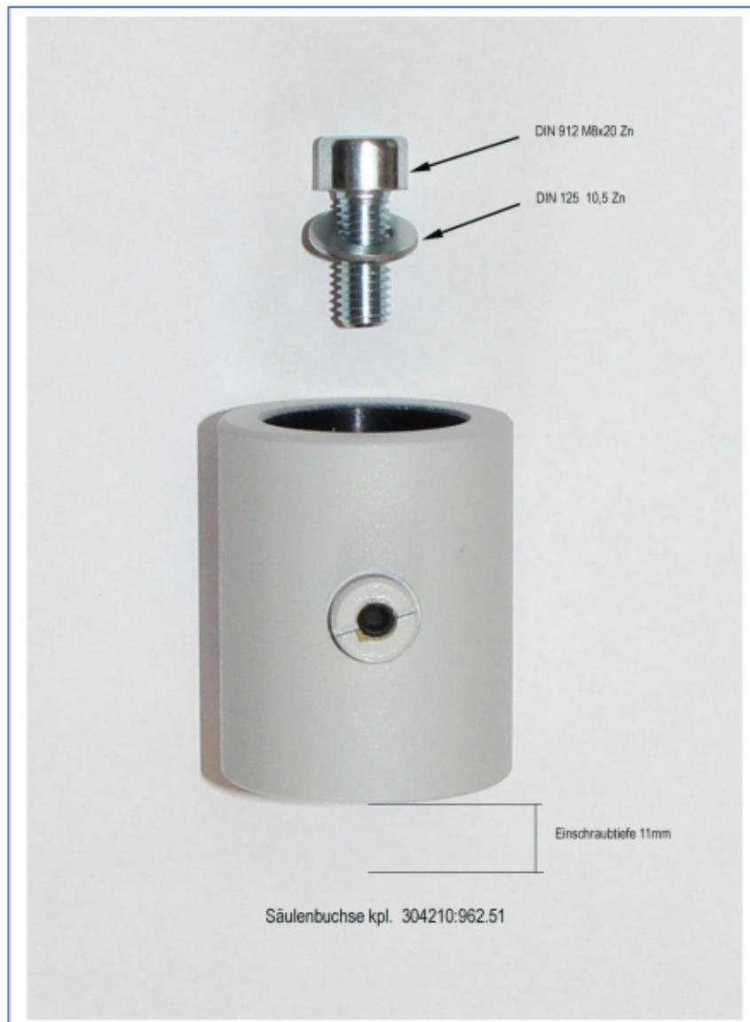
Die Säulenbuchse kann direkt an oder auf Maschinen befestigt werden. Über unsere Säulen mit einem Durchmesser von 29mm kann das Mikroskop mit der Maschine verbunden werden. Es stehen Säulen in den Längen 245mm, 367mm und 600mm zur Auswahl.
